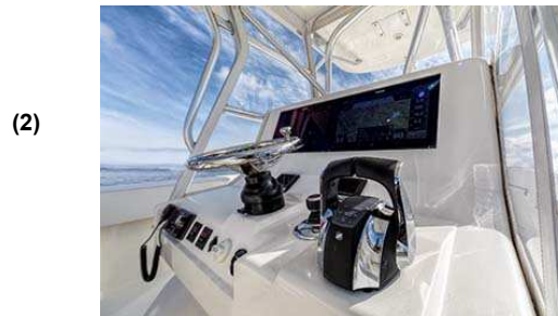
(1) Χειριστήριο εξωλέμβιων κινητήρων με Joystick της Yamaha Motor (2) Σύστημα πλοήγησης Joystick Piloting για εξωλέμβιους κινητήρες της Mercury
