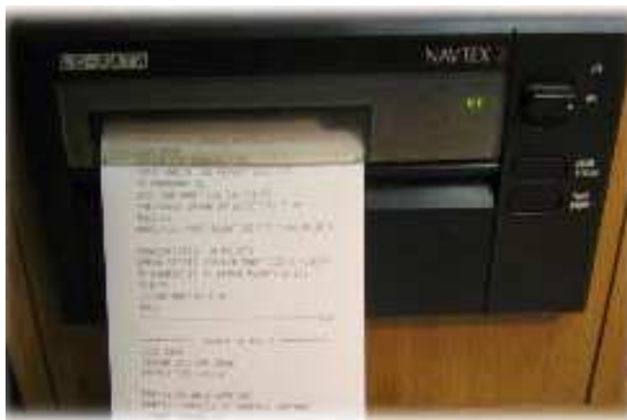
Σύστημα Navtex - Λήψη μηνυμάτων από την συσκευή
