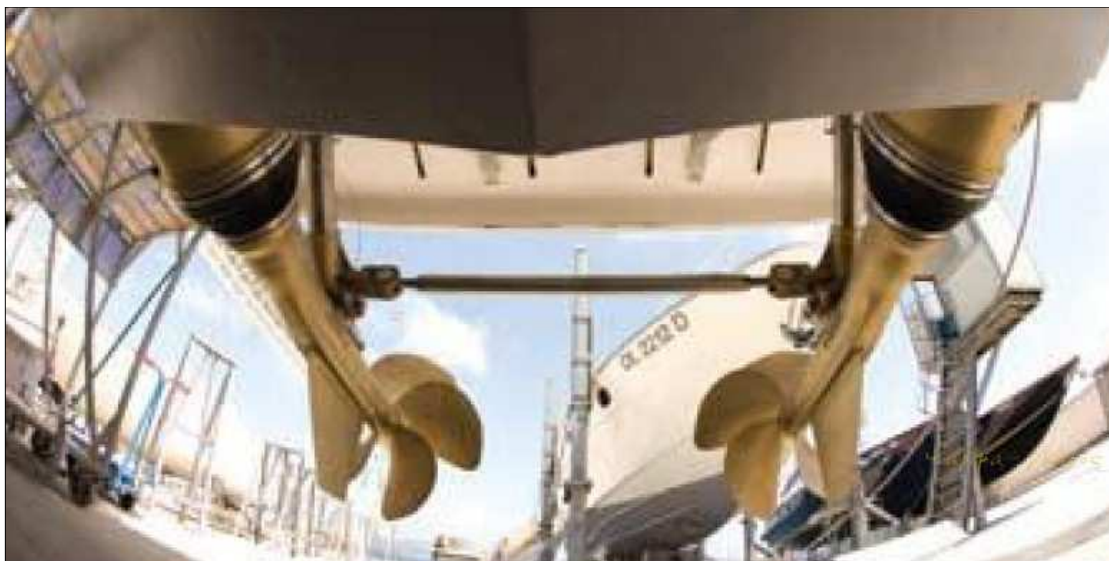
Σύστημα επιφανείας/πρώωσης ARNESON σε υπερσύγχρονο ταχύπλοο σκάφος
