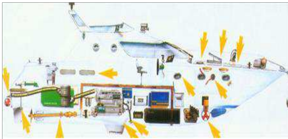
Έλεγκοι για εισροή υδάτων σε ταχύπλοο σκάφος
