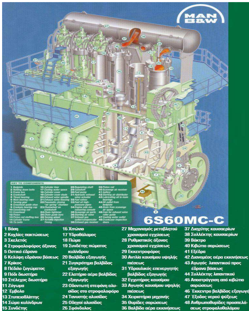
2χρονος εξακύλινδρος, αργόστροφος πετρελαιοκινητήρας, Ισχύος 13.530kW (18.420 hp), Μήκους 7,688m Βάρους 358 τόν.
