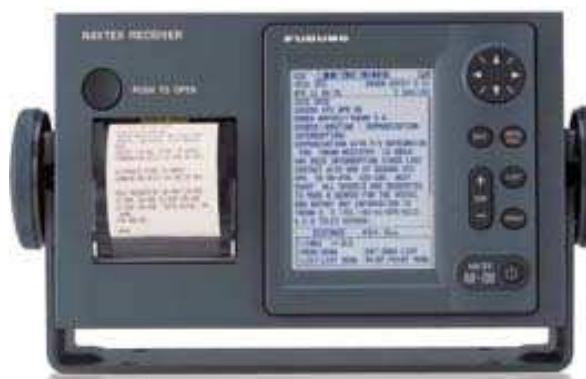
Σύστημα Navtex - Λήψη μηνυμάτων από την συσκευή
