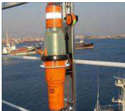
Τύποι Καταγραφέων δεδομένων ταξιδιού/VDR
