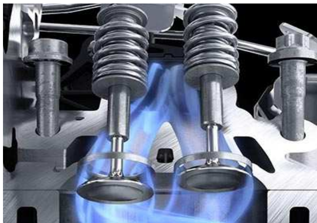
Σύστημα άμεσου ψεκασμού βενζίνης (Gasoline Direct Injection) με άνοιγμα των βαλβίδων εισαγωγής να είναι διαφορετικό σε κάθε κύλινδρο
