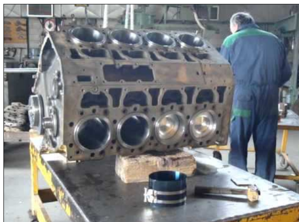
Κορμός (μπλοκ) και κύλινδροι της μηχανής (τύπου V)
