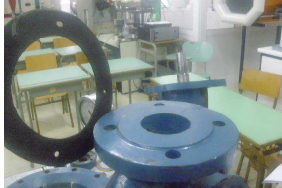
Στεγανοποίηση αντλιών με φλάντζα εξόδου και παρέμβυσμα
