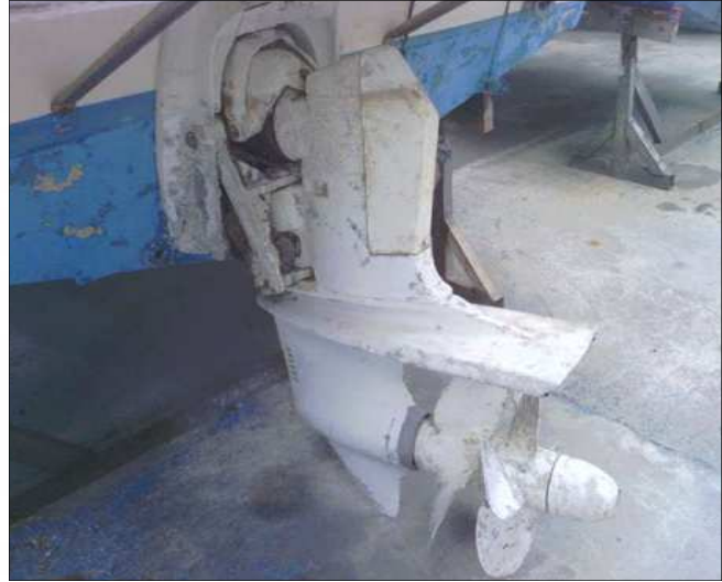
Stern drive έσω-εξωλέμβιας μηχανής που φέρει δύο έλικες και είναι σε περίοδο συντήρησης
