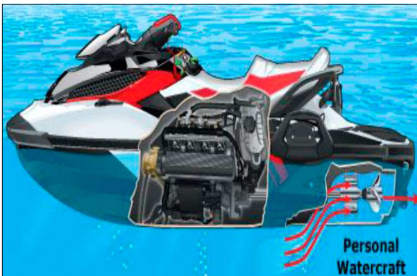
Water jet - Προωθητήρες αντίδρασης
