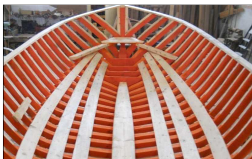
Σχηματική απεικόνιση του εσωτροπίου (μεσαία διαμήκης δοκός) και των πλαϊνών δοκών 3ΑΡ/3ΔΞ ονομαζόμενων στραγαλιές (στήριξη νομέων)
