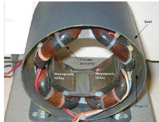
Κατασκευή στάτη μηχανής συνεχούς ρεύματος με τύλιγμα διέγερσης
