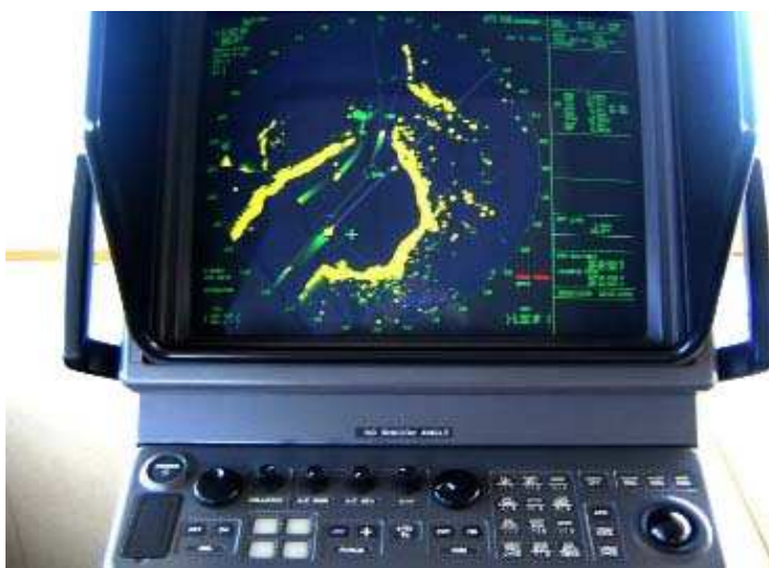
Ραντάρ με ενσωματωμένο σύστημα ARPA
