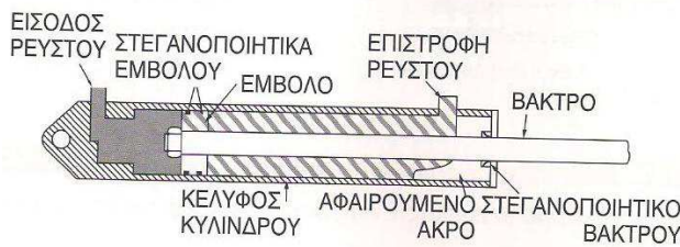
Υδραυλικός κύλινδρος διπλής ενέργειας
