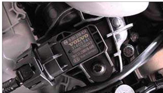
Αισθητήρας απόλυτης πίεσης σε κινητήρα VOLVO
